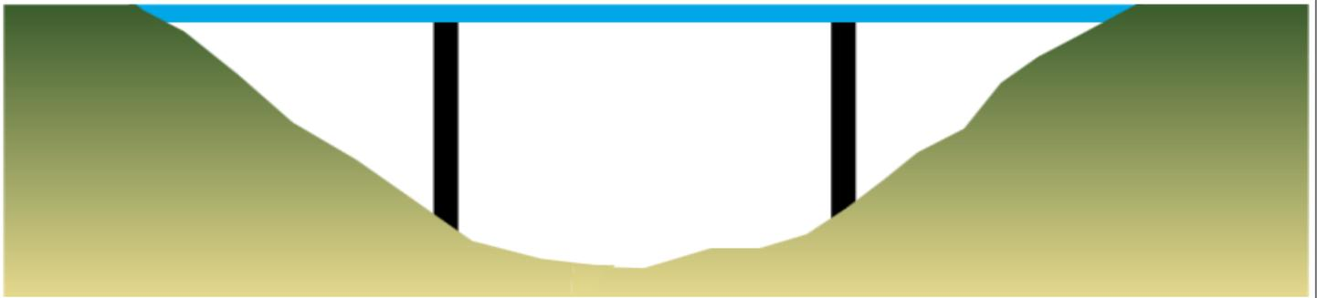
Un pont à poutres est un pont dont le tablier est porté par une ou plusieurs poutres. Les ponts à poutres n'exercent qu'une réaction verticale sur leurs piles intermédiaires ou d'extrémités et les efforts engendrés dans la structure sont principalement des efforts de flexion. Le premier pont à poutres a été construit en 1453 .
